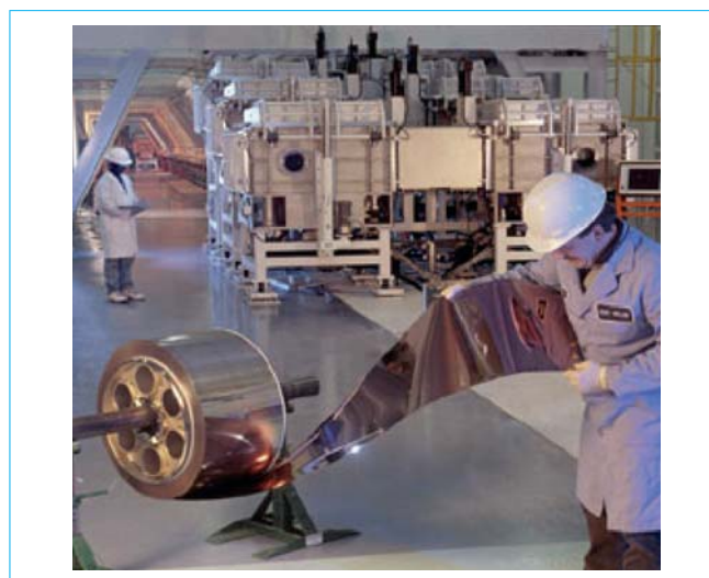
Figure 16 – Tambour sur lequel est enroulée une feuille d'acier inoxydable de plusieurs centaines de mètres de long sur laquelle va être déposé le Si amorphe par PECVD au défilé dans un four à passage
