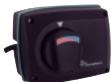
réf. 6231 Servomoteur Somatherm 3 points. Type câble - 230 Volts 5 Nm - 120°.
