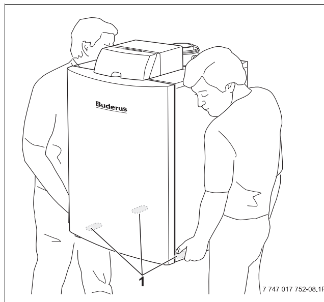
Fig. 8 Transport de la chaudière
