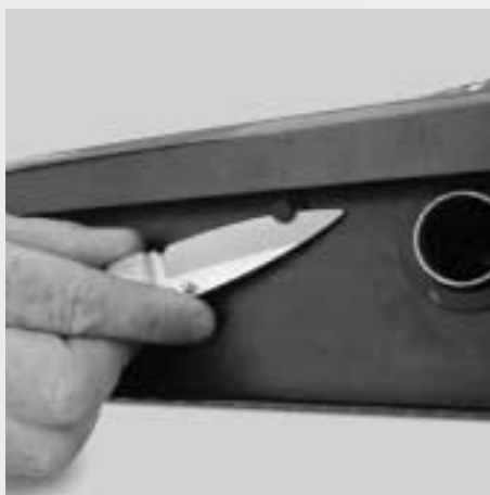
Figure 7.4.2 : Découpe du bouchon de fermeture (uniquement la partie retirée)
