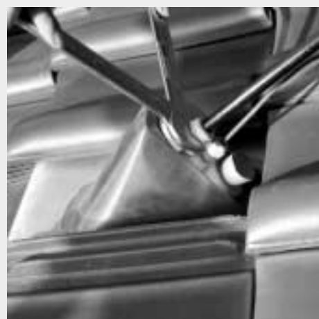
Figure 7.6.7 : Serrage des raccords à vis PG
