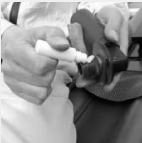
Figure 7.2.9 : Lubrification du bouchon d'étanchéité du raccord de retour avec le lubrifiant fourni à la livraison
