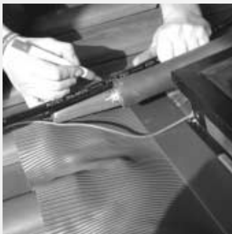
Figure 7.6.8 : Dévissage de l'écrou à chapeau avec bague de blocage, marquage de la longueur de tuyau nécessaire
