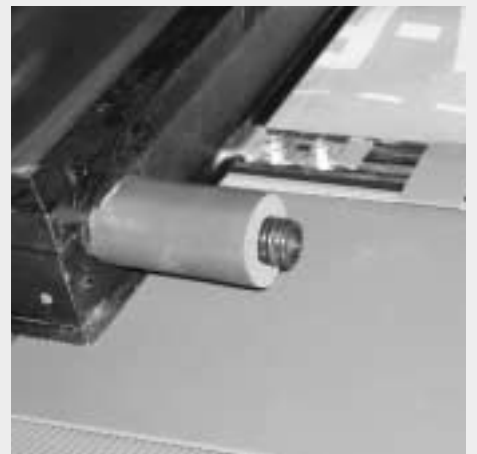
Figure 7.3.3 : Élément de raccordement monté et raccords de blocage à vis rapprochés en butée
