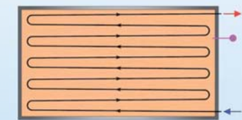
Sens de circulation du fluide dans le capteur
