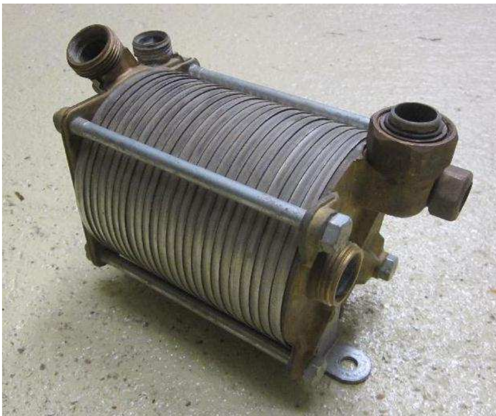
Echangeur à plaques de chaudière gaz
